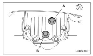
**2.5i (AT)** A) Filler plug B) Drain plug
